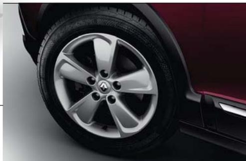
**Le système Extended Grip fonctionne avec un seul et unique type de pneumatiques spécifiques « boue et neige » 16" (Mud & Snow) développés spécifiquement pour Scénic Xmod. Ces pneumatiques permettent d'améliorer l'adhérence sur sols meubles et glissants grâce à une bande de roulement qui offre une meilleure accroche.**
