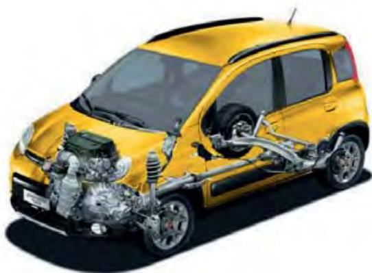
Panda Cross est équipée de deux moteurs, bénéficiant chacun du **Start&Stop** : le moteur essence 0.9 TwinAir Turbo de 90 ch avec boîte de vitesses spéciale à 6 rapports et une première vitesse courte qui accentue les capacités tout-terrain du modèle tout en garantissant d'excellents démarrages en côte, et le diesel 1.3 MultiJet II 16v de 80 ch.
