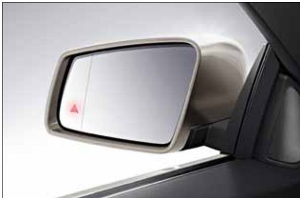
Les avertisseurs de franchissement de ligne et d'angle mort alertent le conducteur dans les situations dangereuses, par exemple un déboîtement.
