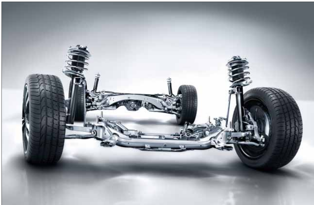
Le train de roulement AGILITY CONTROL avec système d'amortissement sélectif allie agilité et confort de marche : il s'adapte en continu à l'état de la chaussée et au style de conduite.
