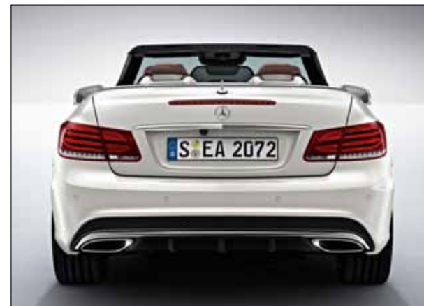
Le Pack Sport AMG propose un système d'échappement à double flux avec sorties trapézoïdales en acier inoxydable poli intégrées au pare-chocs.
