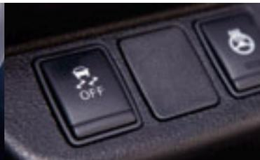
**ESP.** L'ESP (contrôle dynamique de stabilité) vous permet de garder le contrôle. Il ressent les limites de la voiture en matière de souplesse et, le cas échéant, réduit la puissance du moteur ou utilise les freins afin d'éviter tout patinage.
