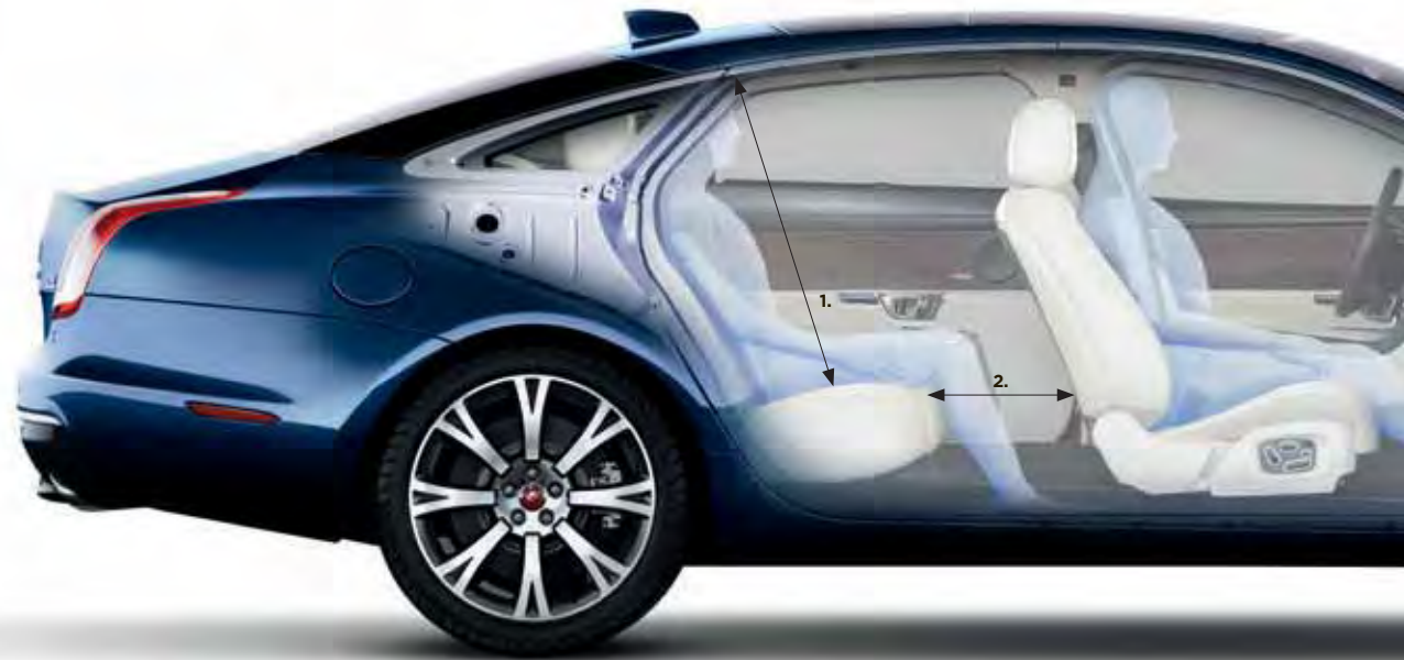
1. Empattement long : espace à la tête 960mm 2. Empattement long : espace aux jambes 1109mm
