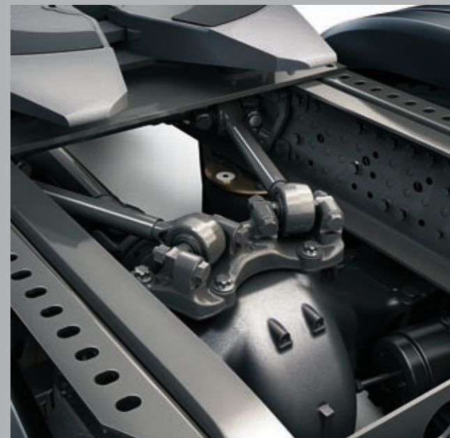
Un nouveau guidage d'essieu arrière : au lieu des triangles traditionnels, le nouvel Actros fait appel à deux bras longitudinaux à intersection des lignes d'appui derrière l'essieu moteur. Outre un guidage plus précis, ce système améliore nettement le comportement autodirectionnel et la stabilité transversale (cf. également pages 39/40).
