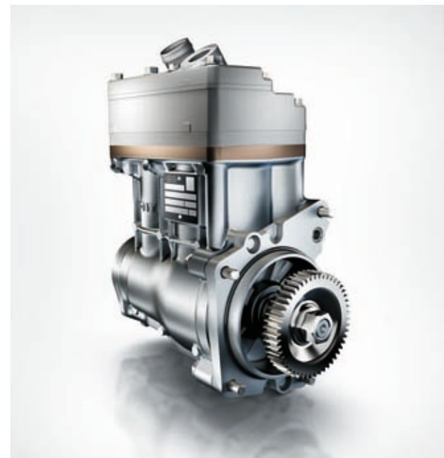
Le compresseur pneumatique à système de compression bi-étagé, pour une consommation d'énergie et des pertes de pression au ralenti optimisées, n'est que l'un des nombreux éléments de série qui contribuent à réduire la consommation du nouvel Actros. Celui-ci se distingue en outre par un poids réduit et une fiabilité en hausse.
